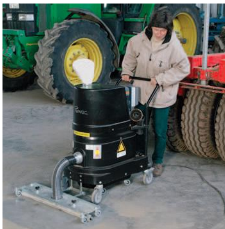
DS 1150 za sesanje na eksplozijskem območju z napravo za talno sesanje v agrarni industriji
